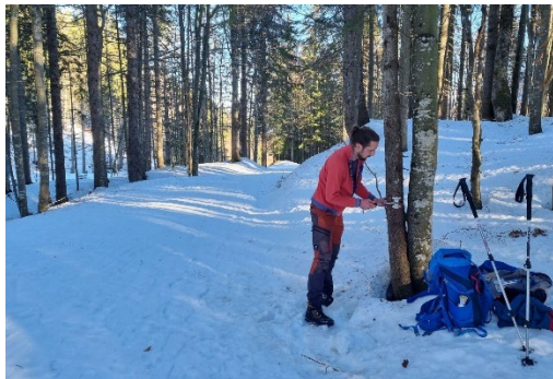
Die Zählgeräte werden mithilfe einer Klemmschelle an einem Baum befestigt.
